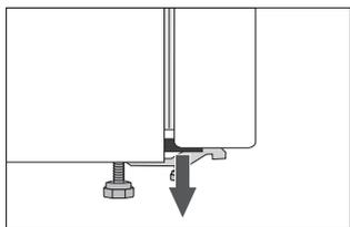
Les coins de la porte sont protégés par des entretoises. Enlevez-les et insérez à la place, dans les orifices, les caches livrés avec l'appareil (uniquement pour certains modèles).
